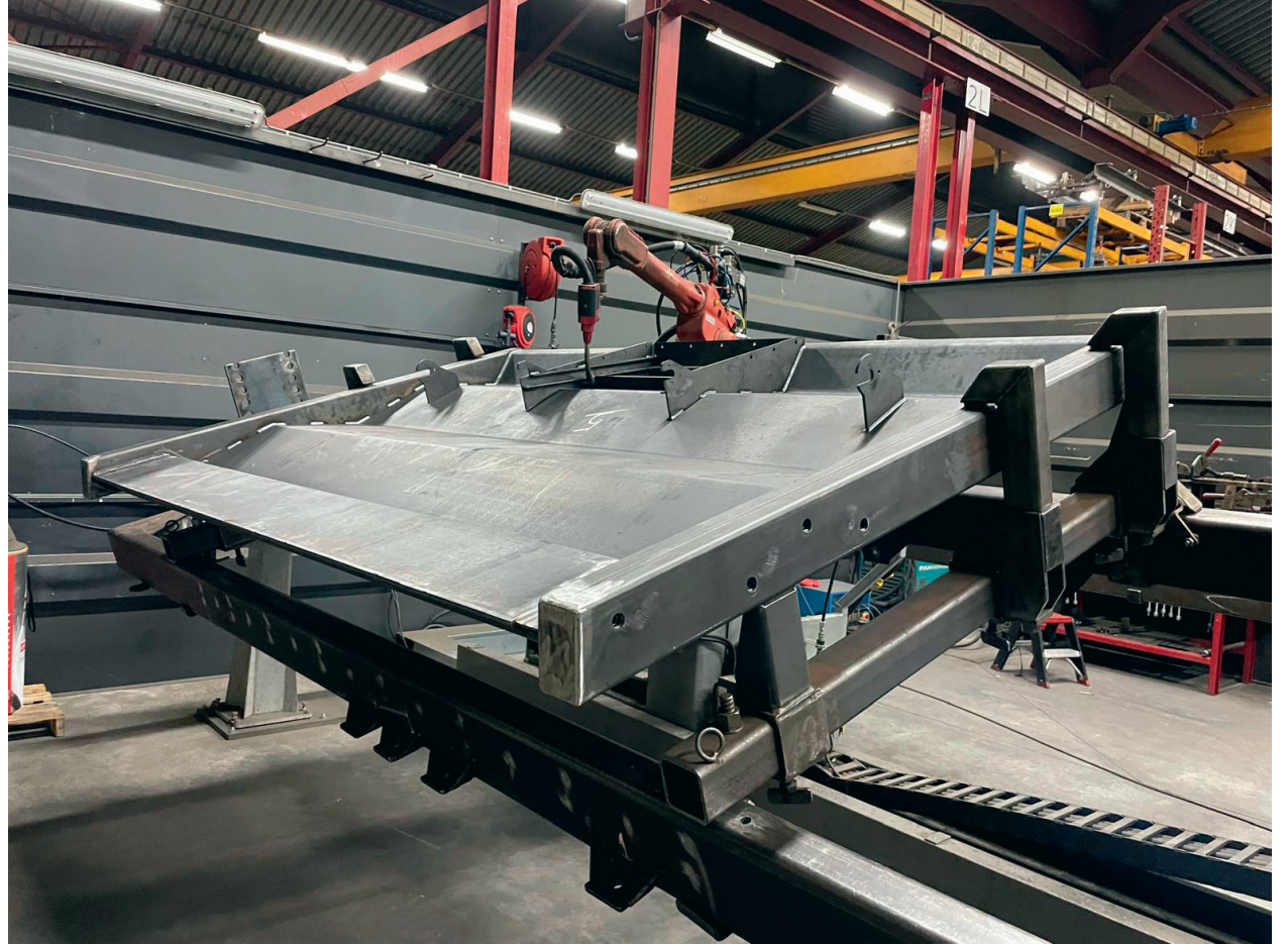
Veenhuis Raalte beschikt over drie robotlasinstallaties.
